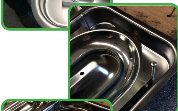
**Ret varme legemet med hånden, så der er luft imellem legemet og parabolen.**
